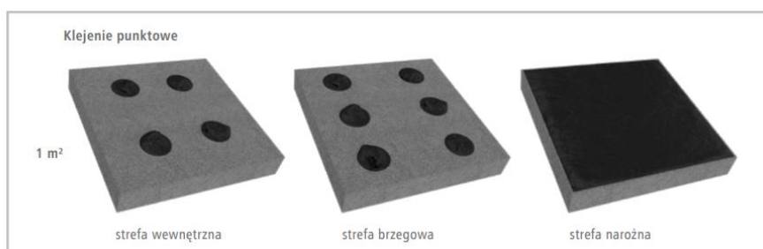
Rys. 4. Klejenie płyt styropapy przy użyciu metody pasmowej i punktowej.
